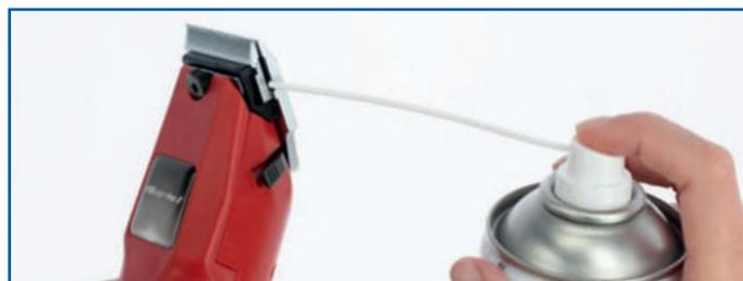
Nach dem Ölen lässt man die Maschine einige Sekunden im Leerlauf laufen, damit sich das Öl gut verteilen kann und nicht auf das Haar des Tieres übertragen wird. Mit der richtigen Wartung und Pflege kann die Haltbarkeit der Scherköpfe bis zu 20 % erhöht werden. Auch das Nachschleifen kann verzögert werden.
